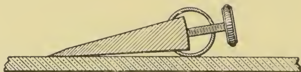
Fig. 3. Entstehung der „Fazette“ beim Abziehen des Messers mit der Abziehvorrichtung (nach Schiefferdecker).
